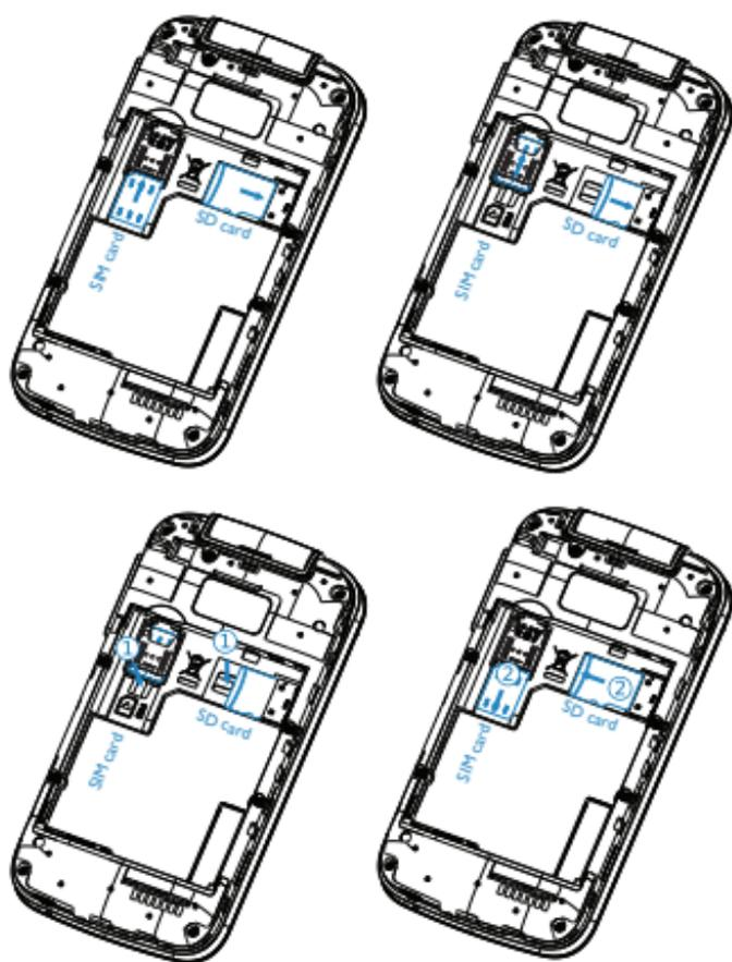
Para extraer la tarjeta SIM o microSD, pulse hacia abajo en la pequeña pestaña de plástico (①) y luego deslice hacia afuera la tarjeta (②). No haga fuerza ni utilice objetos punzantes.
