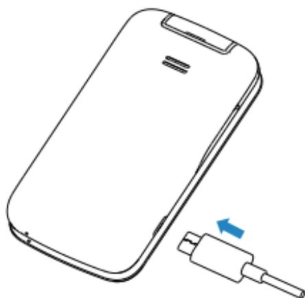
Inserte el extremo pequeño del cable de carga en el puerto de carga como se muestra y conéctelo a la toma de corriente.
