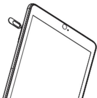
Inserte el clip de la SIM en el orificio fuera de la bandeja de la tarjeta SIM y deslícela hacia afuera con cuidado.
