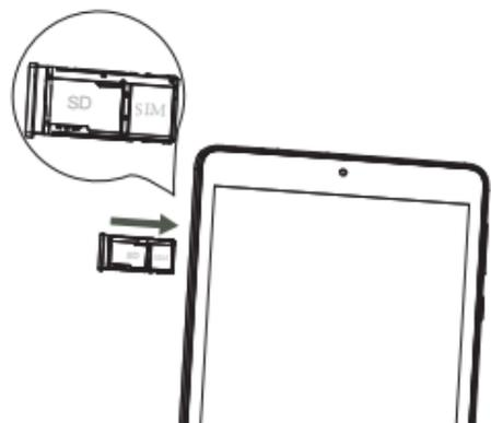
Coloque o extraiga la tarjeta SIM nano y la tarjeta microSD™ en la ranura correcta tal como se indica.
