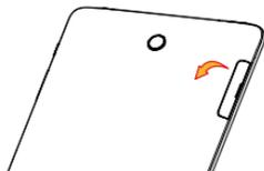
2. Inserte o extraiga la tarjeta SIM nano y la tarjeta microSD.
