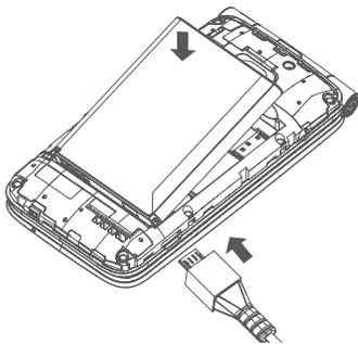
**Paso 4.** Instale la batería de nuevo alineando los puntos de contacto dorados de la batería con los puntos de contacto dorados del teléfono. Sólo encaja de esta forma. Pulse hacia abajo para ajustarla en su sitio.
