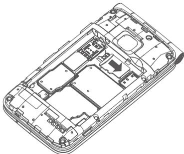
**Paso 3.** Para insertar una tarjeta MicroSD, colóquela en la ranura para tarjeta con los contactos de color dorado hacia abajo.
