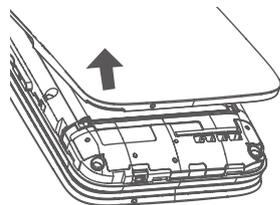
**Paso 1.** Con el teléfono cara abajo, quite la tapa trasera desde la esquina inferior derecha. Use la uña para levantar cuidadosamente la tapa y separarla del cuerpo del teléfono.
