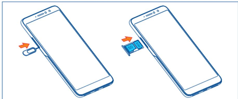
Para instalar la tarjeta microSD/SIM, insértela con el chip hacia abajo en el orificio y deslícela hasta insertarla en la ranura. Para extraer la tarjeta microSD/SIM, presiónela y deslícela hacia afuera.
